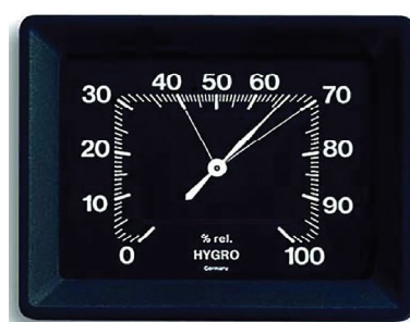
شکل ۱۰۷- رطوبت سنج مناسب نصب شده در انبار
