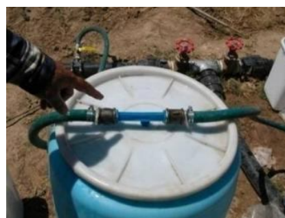
شکل ۲۹- استفاده از شیر ونتوری برای تزریق کود
