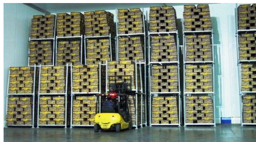
شکل ۱۱۹- نحوه چین پالت‌های پرتقال در سردخانه و فضای باز اطراف پالت‌ها برای حرکت ماشین‌الات
