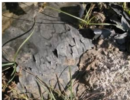
شکل ۴۸- عدم مقاومت پلاستیک نا مرغوب در برابر آفتاب
