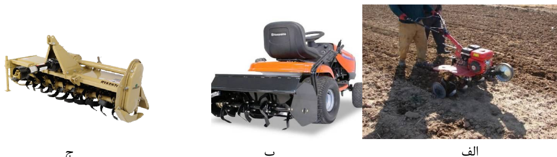
شکل ۱۰- روتیواتور الف- تیلری، ب- باغی و ج- پشت ترک‌توری زراعی
