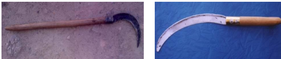
شکل ۷۵- ابزار متداول خارزنی؛ سمت راست: داس سمت چپ: کجک
