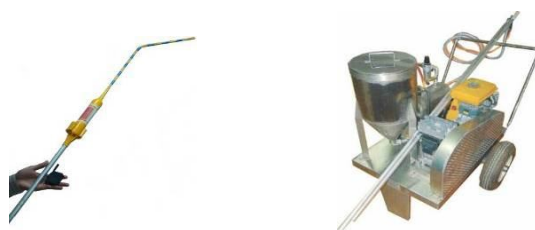
شکل ۷۹- نمونه ای از گرده افشان های در حال توسعه نخل خرما. سمت راست: گرده افشان فرقونی و سمت چپ: گرده افشان تیرکی شارژی
